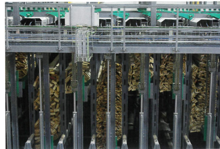
Le trieur Kallfass compte 71 boxes alimentés par le haut. Photo: F. Hermann
